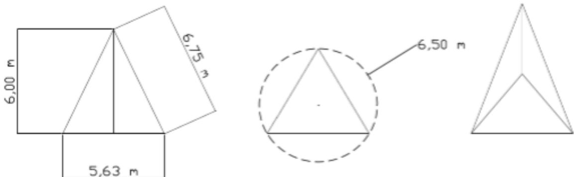
**Pour une hauteur de 4 mètres :** 3 mâts de 4,5 mètres reliés entre eux au sol par des câbles de 5,63 mètres pour un empâtement au sol total de 4,33 mètres de diamètre.
