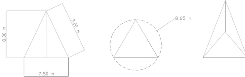
**Pour une hauteur de 6 mètres :** 3 mâts de 6,75 mètres reliés entre eux au sol par des câbles de 5,63 mètres pour un empâtement au sol total de 6,5 mètres de diamètre.
